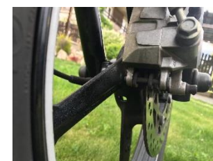
Kontrola stavu brzdových kotoučů/destiček
