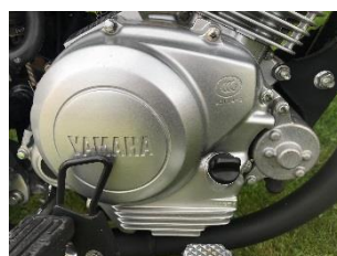
Kontrola množství oleje – měrka
